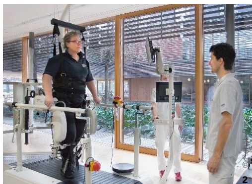
Illustration 1–3: Kipptisch mit Stepper-Funktion (1); Gangroboter (2); endeffektbasiertes Robotikgerät (3). | Illustration 1–3: Table inclinable avec fonction de stepper (1); robot marcheur avec exosquelette (2); dispositif robotique à effecteur terminal (3).
